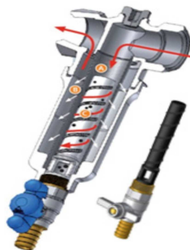
Самопромывной магнитный фильтр
